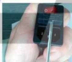
Отсоедините кабель питания и подденьте отверткой держатель предохранителя
